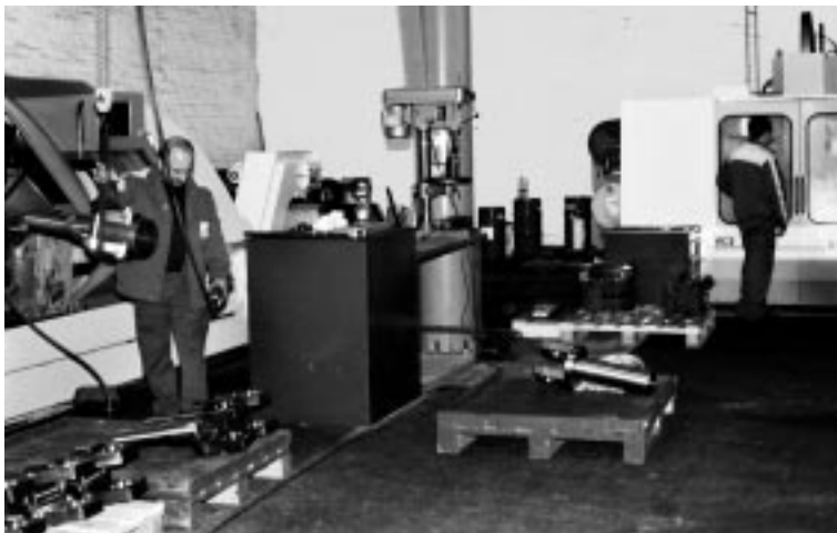
Fig. 1 - Vue partielle de l'atelier où sont installées les machines à commande numérique dont, ici à gauche, un tour Gildemeiste CTX600 et, au fond, un centre d'usinage à broche verticale Mikron, modèle VCE1250.
